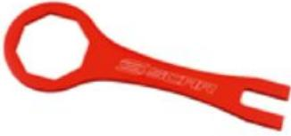
Clé bouchon de fourche SHOWA Ø50mm / 8 pans avec embout teneur de tige
